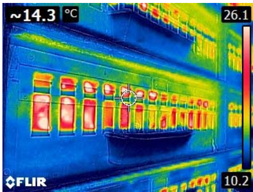
Foto 3: infraroodopname van de duivenmand vanuit de gang in de wagen. De kleur blauw is koel, rood en wit warm (zie het kleurenbalkje rechts in de foto). Duidelijk zichtbaar is dat het in de mand aanzienlijk warmer is dan in de gang.
